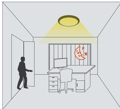
当外界周围环境光低于预设的光感LUX值时，感应器探测到运动物体时，灯会自动亮起。
